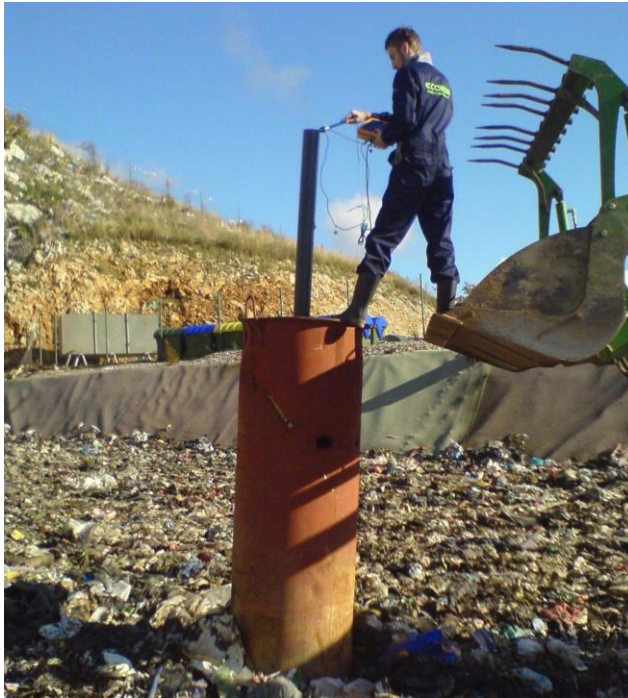
Slika 3 Mjerenje emisija odlagališnog plina na bunaru za pasivno otplinjavanje (foto: D. Jergović)
